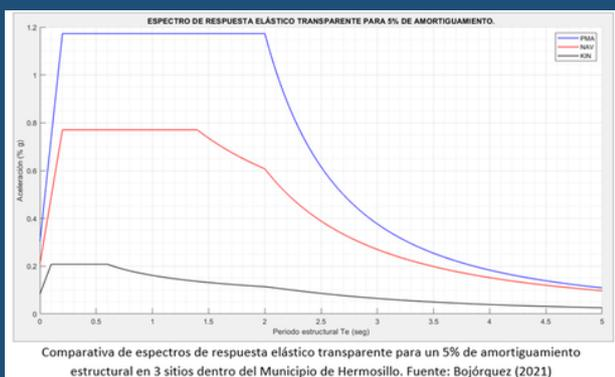
Con los espectros anteriores, se realizó una comparativa de la respuesta estructural para una estructura clasificada como B1 para Estados Límites de Prevención de Colapso (E.L.P.C.) y Estados Límites de Servicio (E.L.S) de los cuales el resultado fue distinto en los 3 sitios investigados.
