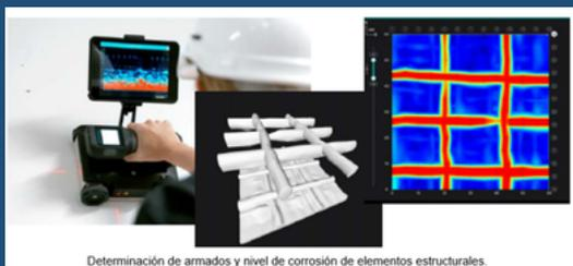
Determinación de armados y nivel de corrosión de elementos estructurales
