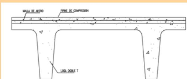
Sistema de losa prefabricada a base de doble T.
