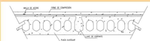
Sistema de losa prefabricada a base de placa alveolar.
