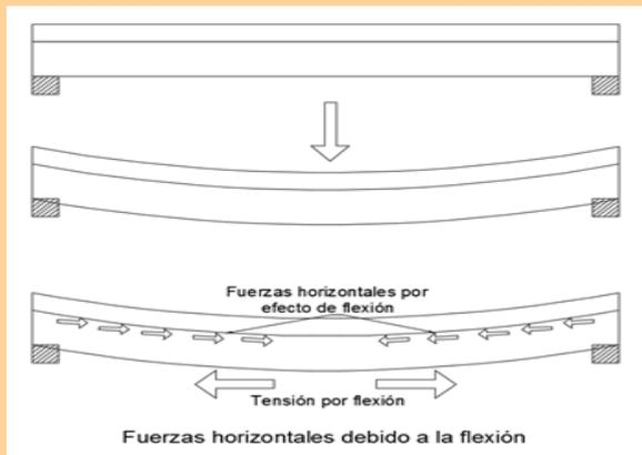
Esas fuerzas horizontales pueden provocar una falla entre el colado y el prefabricado. Para evitar estas fallas se colocará una superficie rugosa si las fuerzas se pueden tomar por la adherencia del concreto. (ver imagen).
