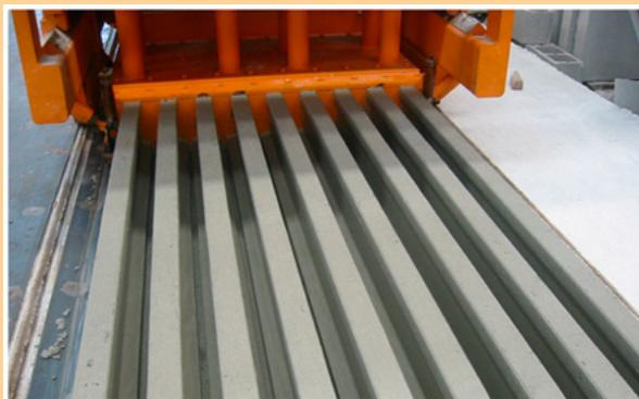
Proceso de extrusión de vigueta pretensada
