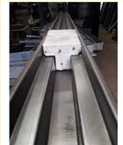
Molde para vigueta pretensada
